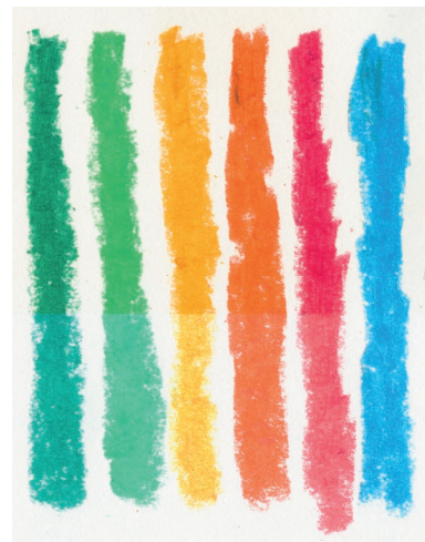
Vergleich der Lichtechtheit nach 8 Wochen am Dachfenster. Links: Neopastel, die Ölpastelle von Caran d'Ache; rechts: preisgünstige Ölpastelle
